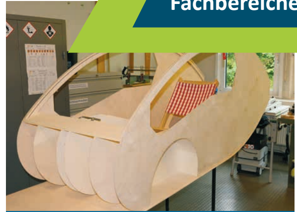
WAT-Projekt: im Bau befindliches E-Mobil
